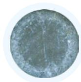
Esta resistencia a la corrosión hace de Magnelis® el recubrimiento perfecto para los ventiladores SISTEVEN. Después de 1440 horas de ensayo de niebla salina sobre una capa Magnelis® no se observa aparición de óxido rojo, mientras que la capa galvanizada aparece completamente corroída.
