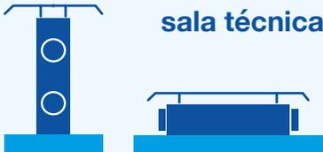
Equipos que pueden trabajar en exteriores y con acceso a los componentes desde los laterales de los mismos. Pueden requerir accesorios como tejadillos o viseras para protección contra lluvia u otros elementos.
